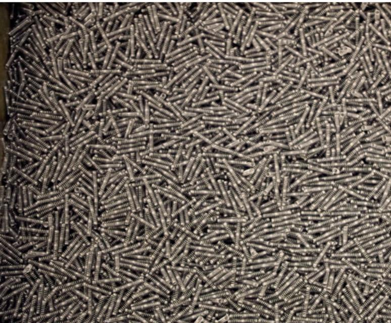
Molle per penne biro utilizzate nei sistemi di assemblaggio automatico.
